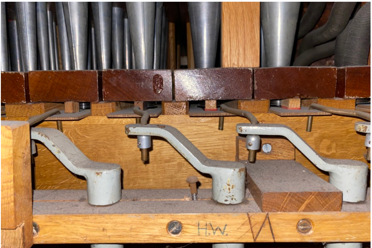
De registerslepen van de windlade van het Hoofdwerk
